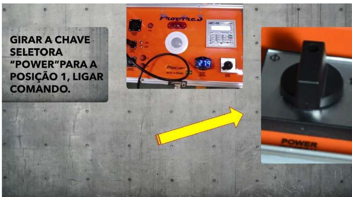
OBSERVAR A TENSÃO DA BATERIA, NORMAL É ENTRE 24 E 25,5 VOLTS. QUANDO ESTIVER EM RECARGA, FICARÁ ENTRE 27 E 28 VOLTS
