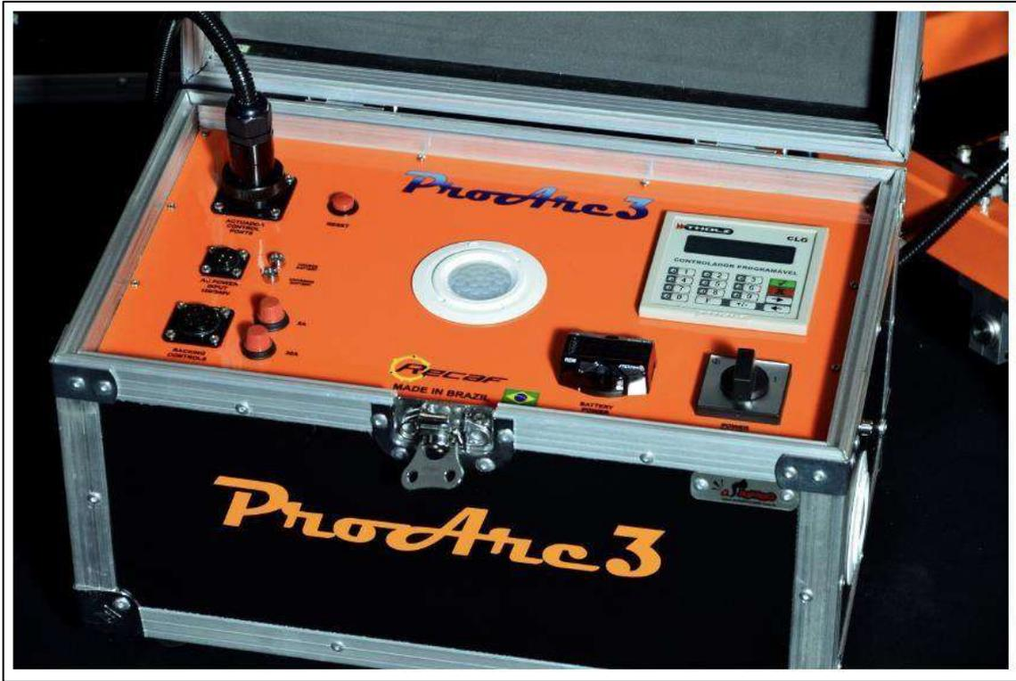
Todo o sistema operacional do ProArc3 está concentrado na Caixa de Comando, composto por um Controlador Lógico Programável, relés e bateria 24 volts 9 amperes; um Carregador inteligente 100/240 volts AC, protegendo e aumentando a vida útil das baterias; e sinalizadores visuais de carga em lâmpada LED vermelha.
