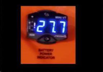
NÃO INICIAR MANOBRA SE A TENSÃO DA BATERIA ESTIVER ABAIXO DE 23,6 VOLTS OU LED LIGADO, NESTE CASO O EQUIPAMENTO NÃO SERÁ ACIONADO E A MALETA DEVERÁ SER CONECTADA A UMA TOMADA PARA RECARGA. (Tensão de 100 a 240 volts)
